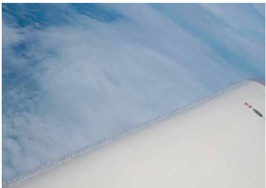
Bei Wolkenflügen im entsprechenden Temperaturbereich unter 0°C kann sich leicht Eisansatz bilden; meist zuerst als kleiner Eisrand an der Flügelvorderkante, wie hier im Bild zu sehen.
