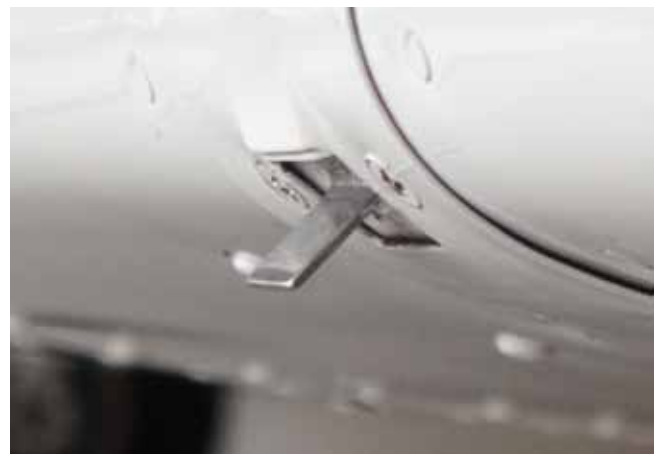
Auf die Überprüfung der Funktionsfähigkeit der Überziehwarnanlage sollte man auf keinen Fall verzichten.
