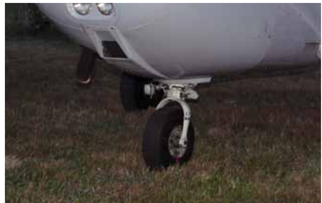
Diese Bugradfederung ist eindeutig kaputt.
