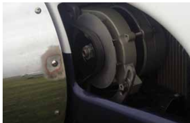
Ist der Keilriemen, wie hier, leicht zugänglich, muss er auf festen Sitz und Beschädigungen hin überprüft werden.
