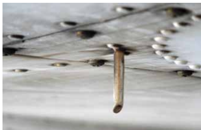
Die Tankentlüftung unterhalb der Tragfläche darf nicht verstopft sein.
