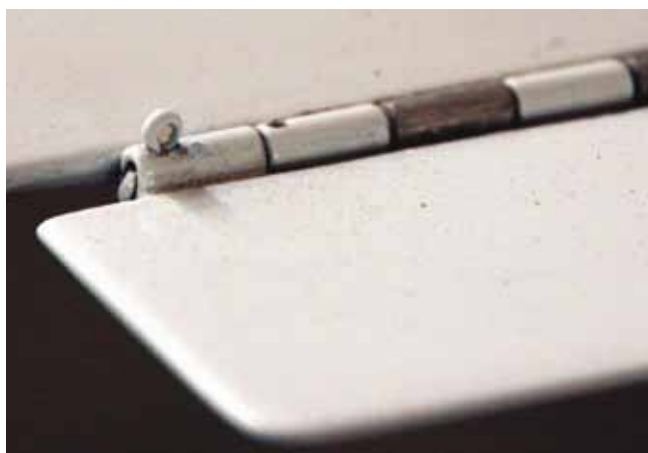
Bei der Überprüfung von Scharnieren muss man auf den festen Sitz der Sicherungssplinte achten.
