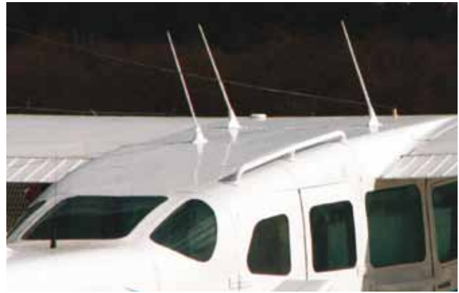
Die Überprüfung der Antennen auf Beschädigung gehört auch zur Vorflugkontrolle.
