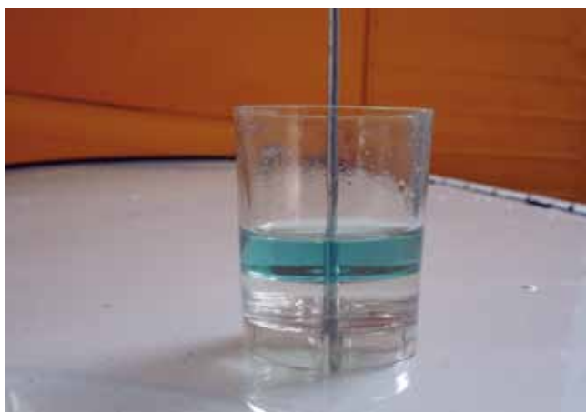
Bei dieser Kraftstoffprobe kann man klar erkennen, dass sich Wasser unterhalb des (blauen) Kraftstoffs abgesetzt hat.
