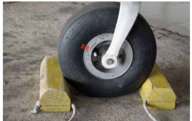
Die Entfernung der Bremsklötze darf man nicht vergessen, sonst erlebt man beim Wegrollen eine böse Überraschung.
