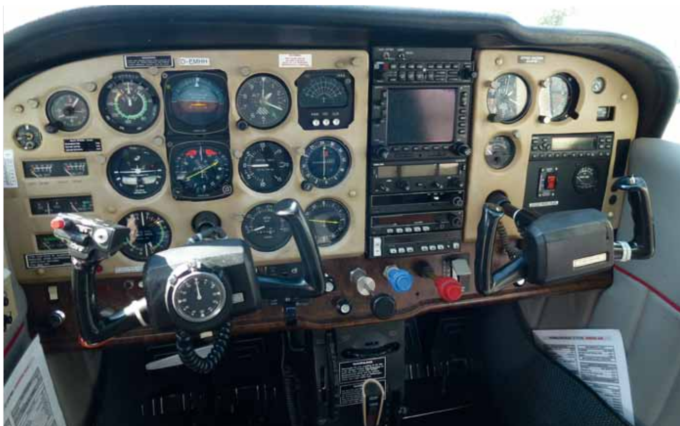
Die „klassische“ Cockpit-Instrumentierung eines einmotorigen Flugzeuges.
