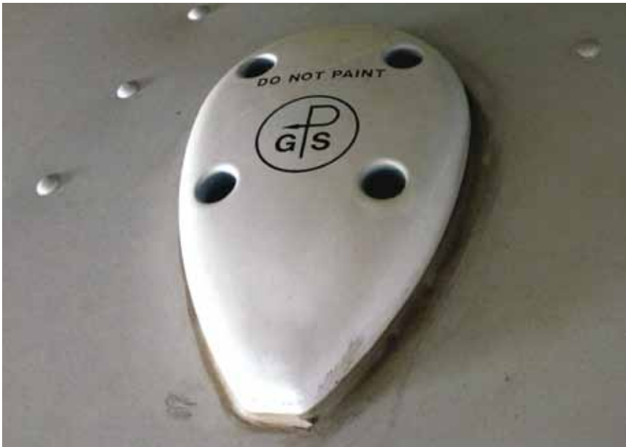
Oben auf dem Flugzeugrumpf montierte GPS-Antenne
