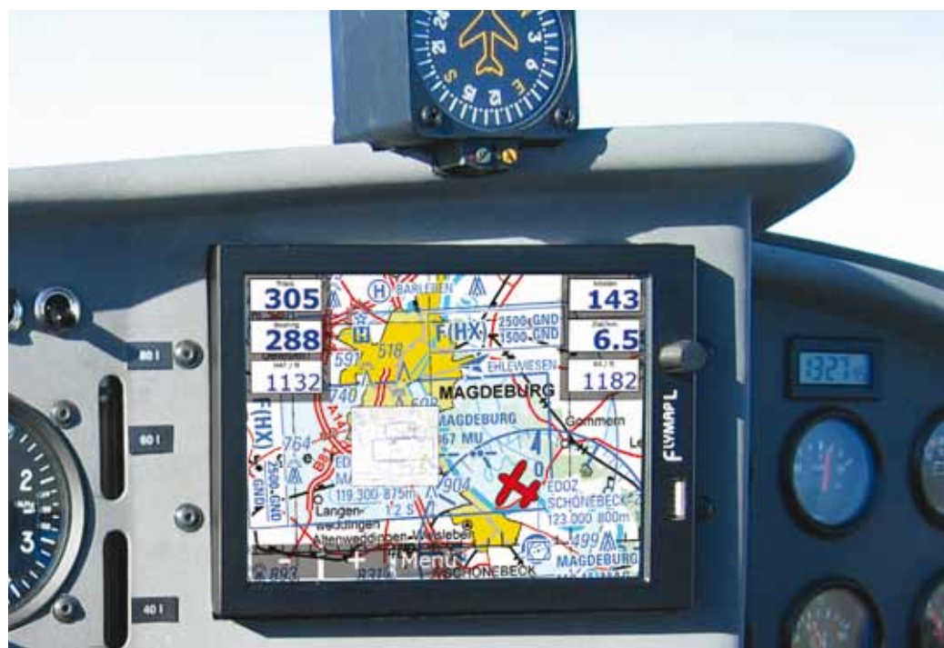
Fest eingebautes MovingMap-System mit ICAO- und Anflugkarte
