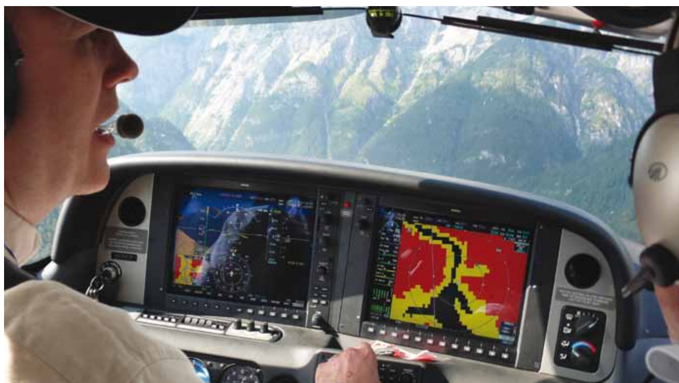
Modernes Cockpit mit GPS-Multifunktionsnavigations-System
