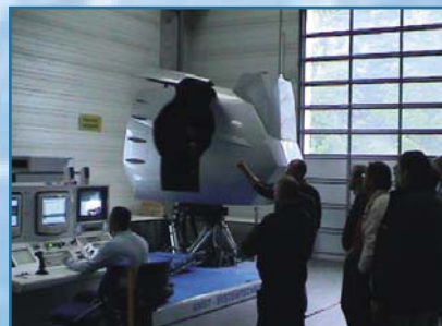
Der AIRFOX DISO, ein neuartiges Trainingsgerät zum Erkennen und Beherrschen von Effekten der räumlichen Desorientierung
